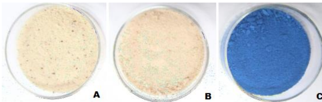
Figura 4. Aspecto das biomassas das leveduras liofilizadas. A) Biomassa antes da modificação química; B) Biomassa após o processo de modificação química; C) Biomassa modificada quimicamente após o processo de bioadsorção do corante.
