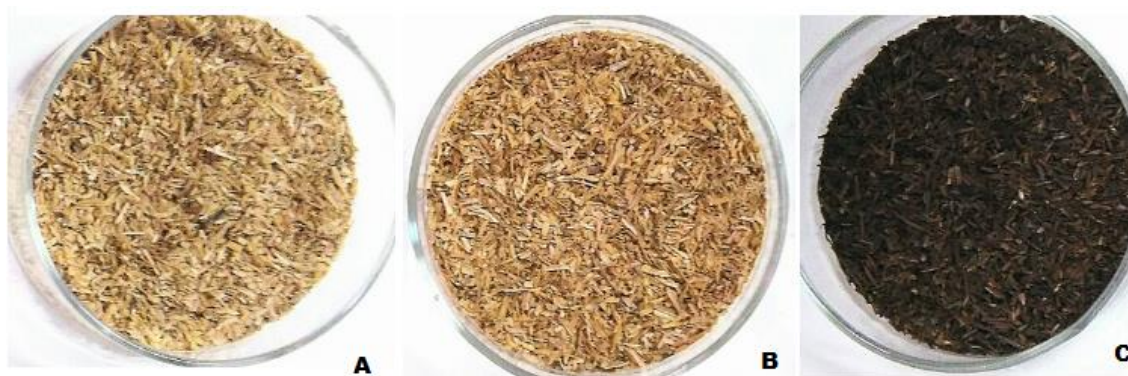
Figura 5. Aspecto da biomassa de casca de arroz triturada. A) Biomassa antes da modificação química; B) Biomassa após o processo de modificação química, C) Biomassa modificada quimicamente após o processo de bioadsorção.
