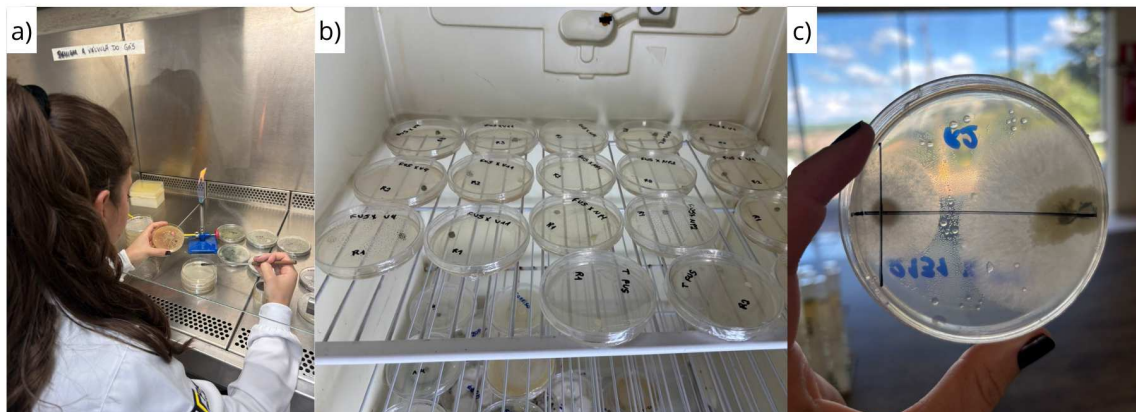
Figura 3- Etapas da condução do ensaio de confronto direto entre microrganismos: (a) montagem do experimento em câmara de fluxo laminar; (b) placas de Petri® incubadas em câmara de crescimento do tipo BOD; (c) marcação do crescimento do patógeno para realização das avaliações diárias.
