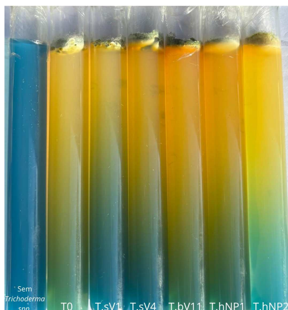
Figura 11- Halo de solubilização de potássio dos isolados T.sV1, T.sV4, T.bV11, T.hNP1 e T.hNP2, em meio de cultura Pikovskaya modificado, após sete dias de avaliação.
