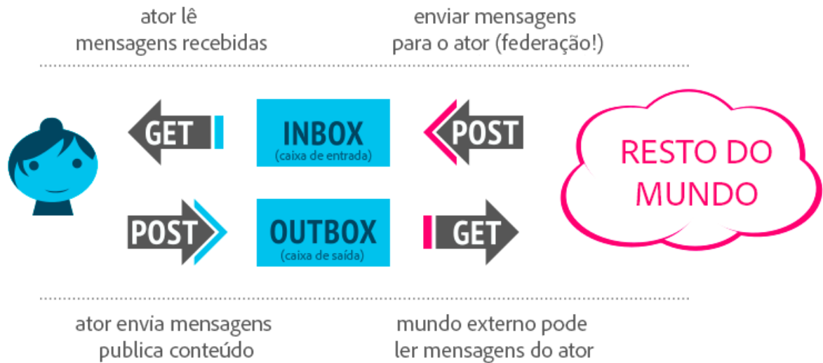
Figura 6 – Funcionamento básico da comunicação utilizando ActivityPub.
