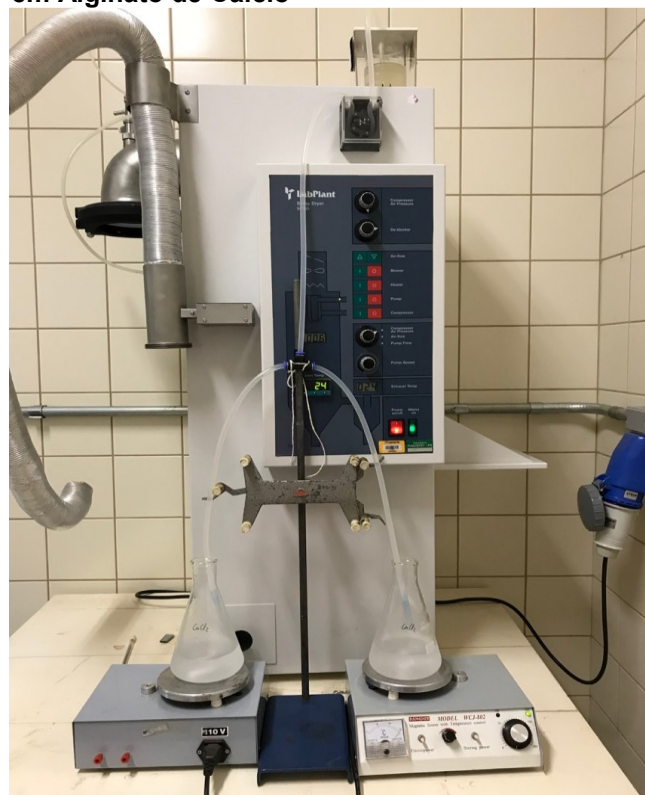
Figura 12 - Equipamento Utilizado Para a Encapsulação de Leveduras em Alginato de Cálcio
