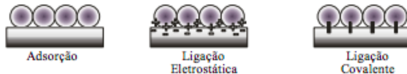
Figura 3 - Ligações Entre a Célula e o Suporte de Imobilização
