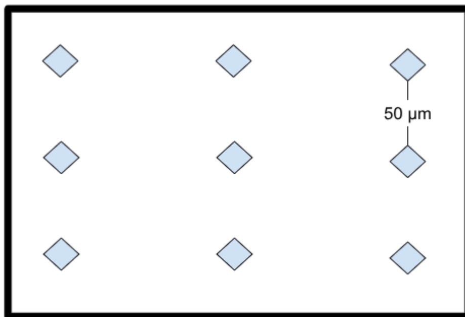
Figura 14 - Esquema de medições de microdureza.
