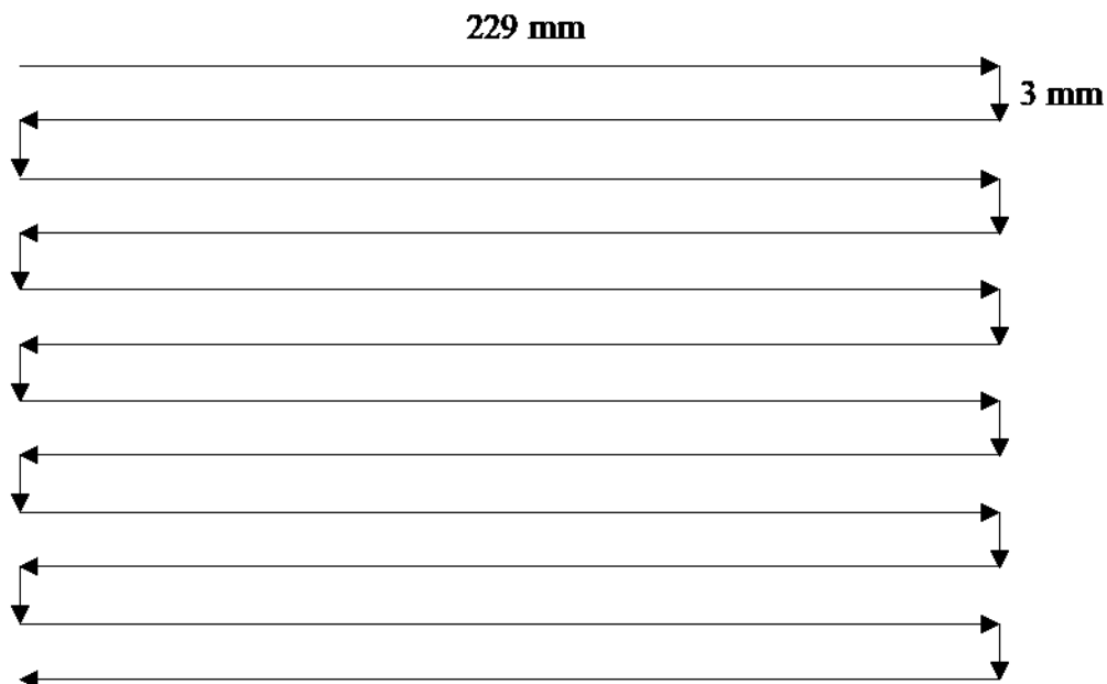
Figura 12 - Esquema da trajetória de varredura durante um passe de deposição.
