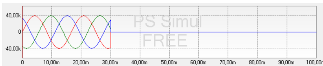
Figura 13. Sinal de tensão no secundário do transformador de potência
