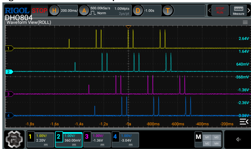
Figura 16 – Forma de onda para o veículo de 7 eixos classe 3D4.
