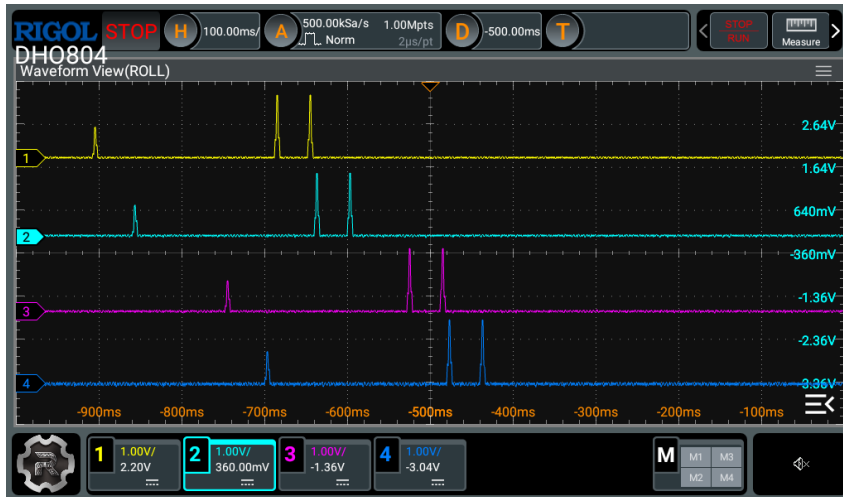
Figura 13 – Forma de onda para o veículo de 3 eixos classe 3C.
