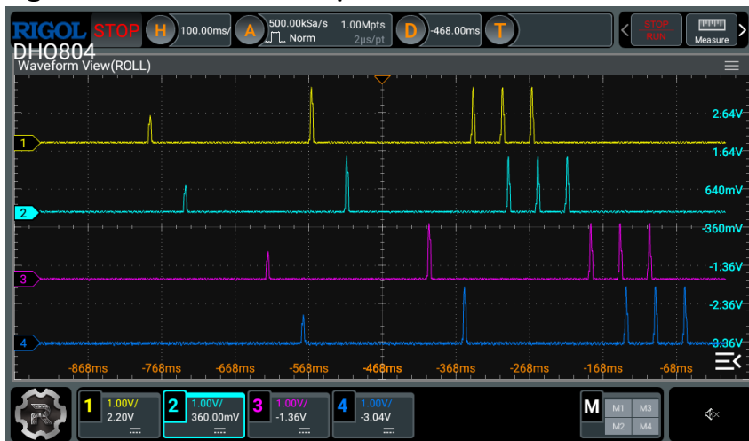
Figura 14 – Forma de onda para o veículo de 5 eixos classe 2S3.
