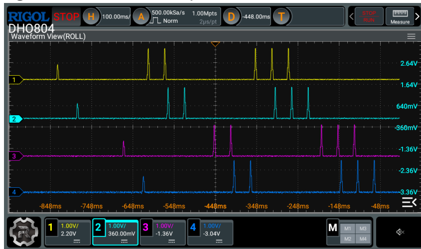
Figura 15 – Forma de onda para o veículo de 6 eixos classe 3S3.
