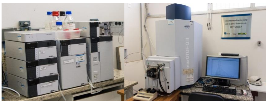
Figura 9 – Cromatógrafo líquido HPLC/MS- (20AD-LC-MS, Shimadzu) com ionização por eletrospray e tempo de voo quadrupolo (microTOF-Q II, Bruker Daltonik).
