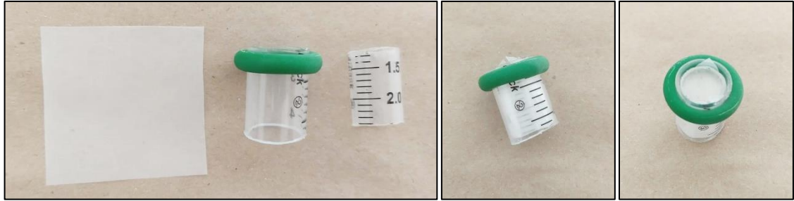
Figura 4 - Aparatos utilizados para o TIML, confeccionados a partir de seringas descartáveis com volume de 5 e 3 mL, anéis de borracha para castração (ovinos, caprinos e bezerros) e malha de nylon com abertura de 25 \mu\text{m} . Fonte: Arquivo pessoal (2018).
