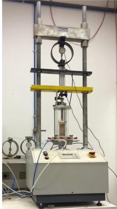
**Figura 15 – Célula com amostra para o ensaio de Módulo Resiliente**
