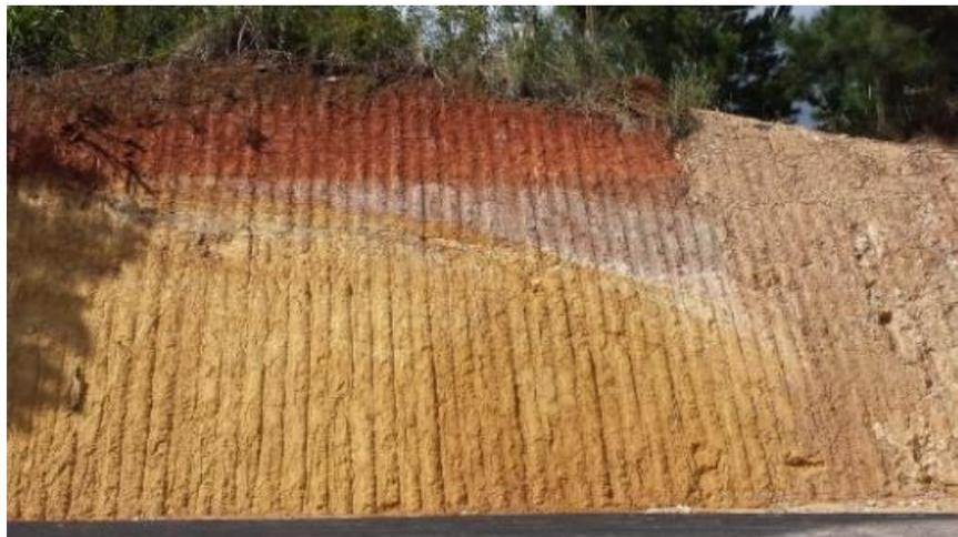
Foram coletados 6 tambores de amostra deformada com aproximadamente 330 quilos de solo em cada, a umidade higroscópica do solo é de 39,56% e o peso específico natural é igual a 16,176 kN/m<sup>3</sup>.
