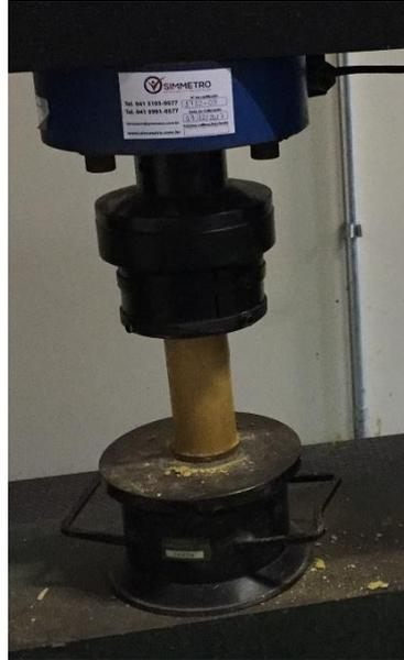
O resultado de resistência à compressão não confinada ( $q_u$ ) foi calculado a partir da equação (Equação 3):
