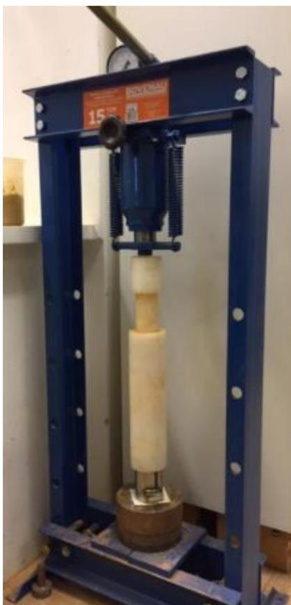
Os corpos de prova foram moldados logo após a sua mistura, procurando-se obter o teor de umidade mais próximo do ótimo ( $\pm 0,5\%$ ) e um peso específico aparente seco não diferindo mais que 1% do obtido na curva de compactação. Em seguida, os corpos de prova foram embalados com papel filme, identificados e armazenados em câmara úmida para o
