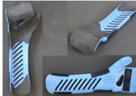
FIGURA 13 – ÓRTESE DE PUNHO, MÃO E DEDOS CUSTOMIZADA FABRICADA POR EXTRUSÃO DE MATERIAL
