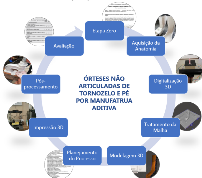
FIGURA 46 – PROCEDIMENTO PARA FABRICAÇÃO DE ÓRTESES NÃO ARTICULADAS DE TORNOZELO E PÉ (AFO) POR MANUFATURA ADITIVA
