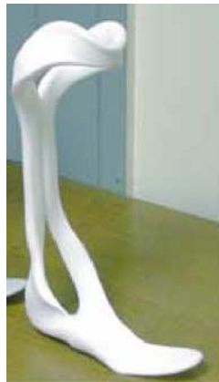
FIGURA 17 – ÓRTESE DE TORNOZELO E PÉ PRODUZIDA POR SLS
