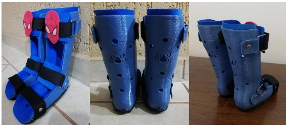
FIGURA 49 – ÓRTESES DE TORNOZELO E PÉ FABRICADAS POR MANUFATURA ADITIVA – CASO1
