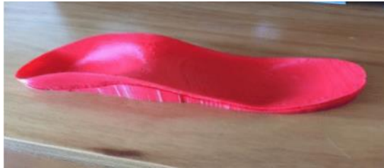
FIGURA 23 – PALMILHA PRODUZIDA POR EXTRUSÃO DE MATERIAL
