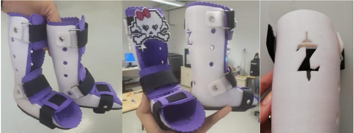
FIGURA 57 – ÓRTESES DE TORNOZELO E PÉ FABRICADAS POR MANUFATURA ADITIVA – CASO 4
