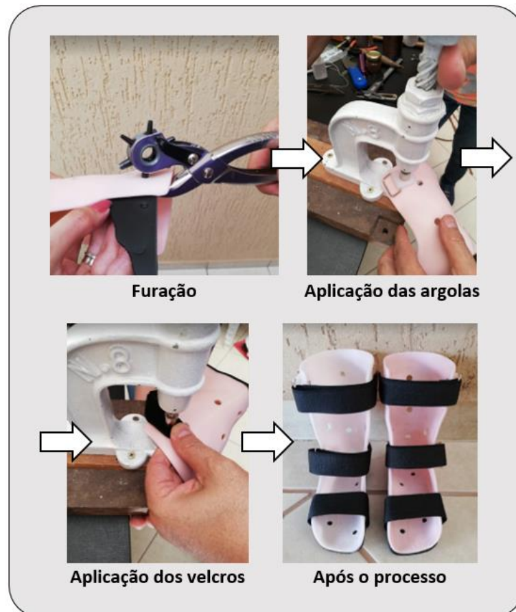
FIGURA 45 – APLICAÇÃO DAS ESTRUTURAS DE FIXAÇÃO E VELCROS
