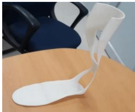
FIGURA 24 – ÓRTESE DE TORNOZELO E PÉ FABRICADA EM ABS POR EXTRUSÃO DE MATERIAL
