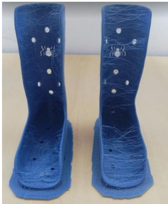
FIGURA 44 – ÓRTESES COM EFEITO TEIA APÓS A IMPRESSÃO 3D
