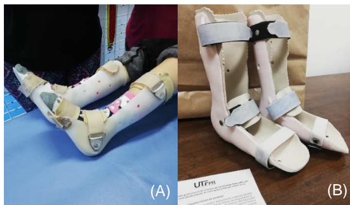
FIGURA 56 – (A) ÓRTESE AFO TRADICIONAL (B) ÓRTESE AFO IMPRESSA COM SUGESTÕES DE MELHORIAS, PARA O USUÁRIO DO CASO 3
