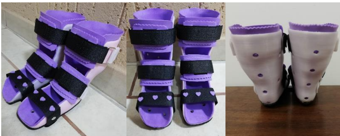
FIGURA 52 – ÓRTESES DE TORNOZELO E PÉ FABRICADAS POR MANUFATURA ADITIVA – CASO 2
