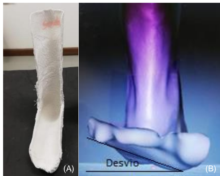
FIGURA 31 – (A) MOLDE PARCIAL EM ATADURA GESSADA; (B) MOLDE DIGITALIZADO INVIÁVEL PARA USO POR CAUSA DO DESVIO NA PLANTA DO PÉ
