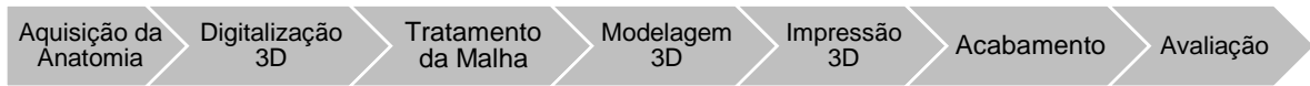
FIGURA 12 – ETAPAS DO DESENVOLVIMENTO DE ÓRTESES DE MEMBRO SUPERIOR UTILIZANDO DIGITALIZAÇÃO E IMPRESSÃO 3D
