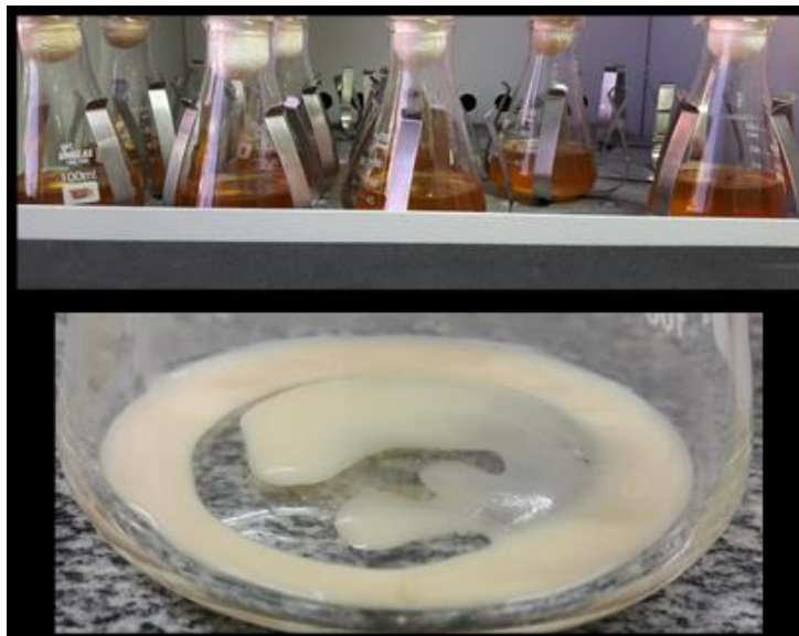
Figura 12 - Cultivo da Saccharomyces cerevisiae em meio YPG com agitação em shaker a 130 rpm por 24 horas a 30°C e obtenção da biomassa celular após centrifugação a 10.000 x g por 5 min a 4°C
