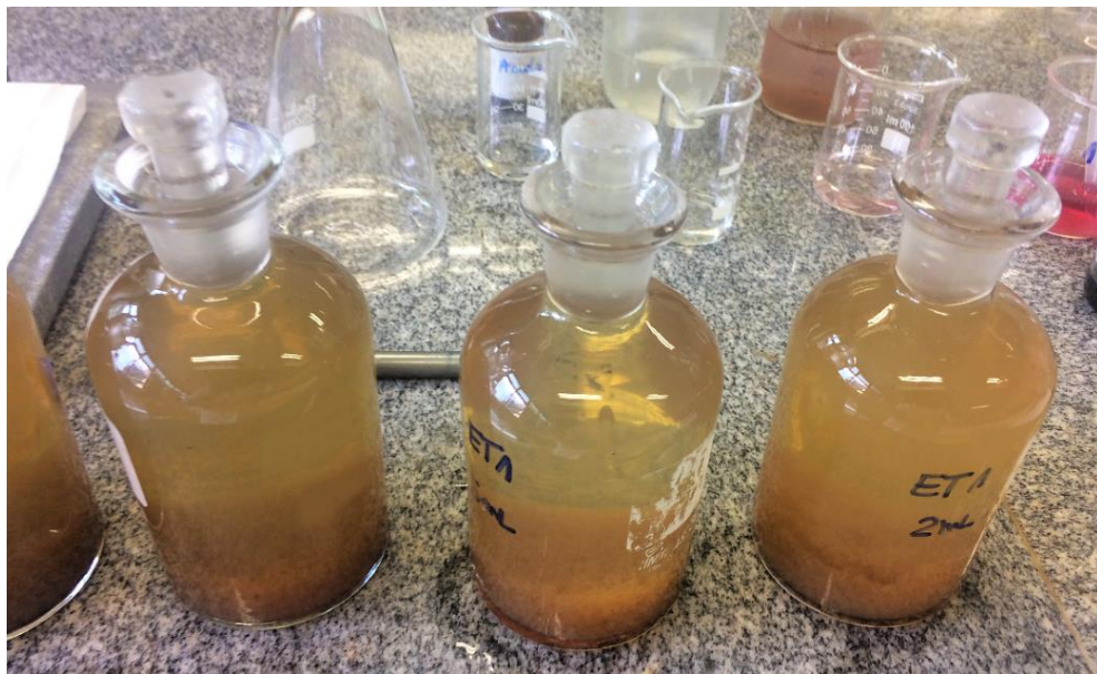
Figura 16- Fotografia dos frascos de Winkler após adição de ácido sulfúrico ( H_2SO_4 ).
