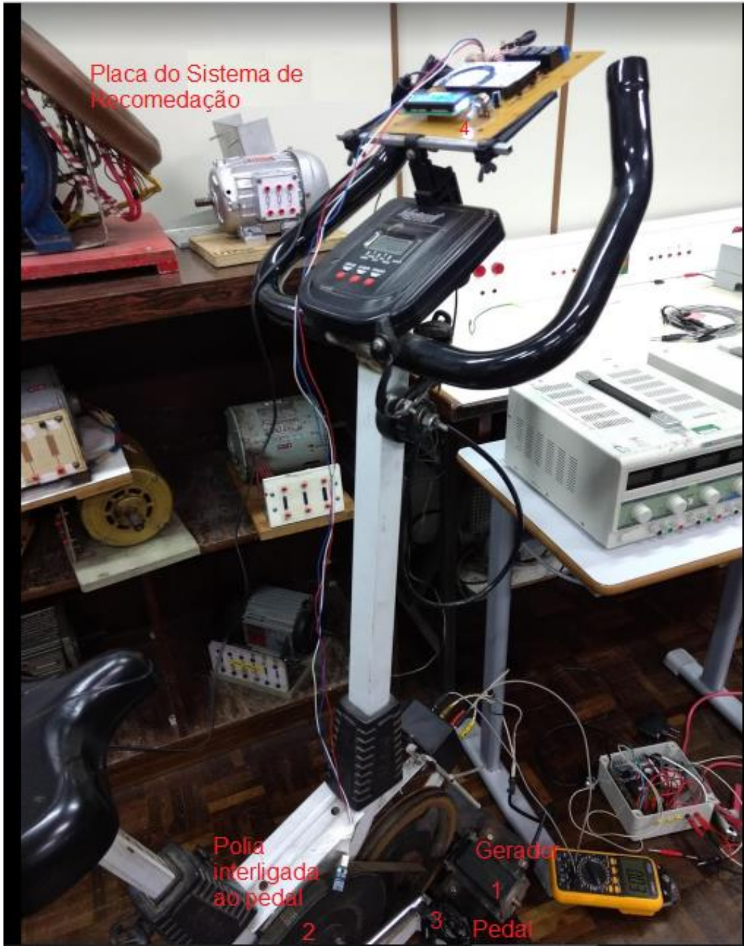
Figura 6 - Bicicleta Ergométrica com Sistema de Recomendação e de Microgeração de energia
