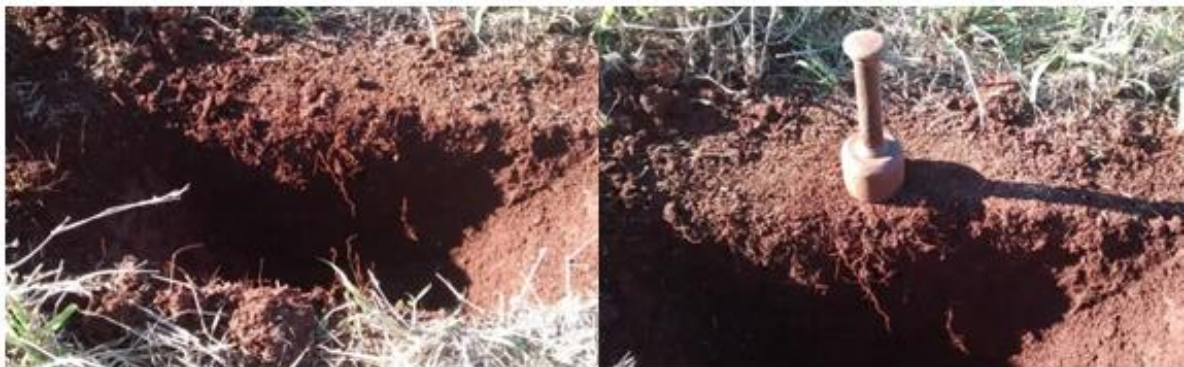
Figura5- Trincheira e extrator utilizado para coleta dos anéis de solo com estrutura preservada. Fonte: Mezzalira – 2018.
