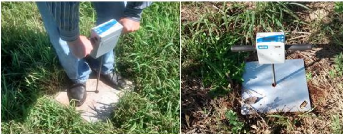
Figura6. Pontos de coleta das amostras de RP utilizando o penetrômetro digital, marca Falker®. Fonte: Mezzalira – 2018.
