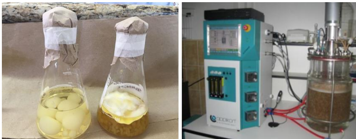
Figura 6- Cultivo de micélio de Ganoderma lucidum em meio líquido (A) em erlenmeyer; (B) em biorreator Fonte: (A) o autor (2019); (B) Petre e Petre (2013).
