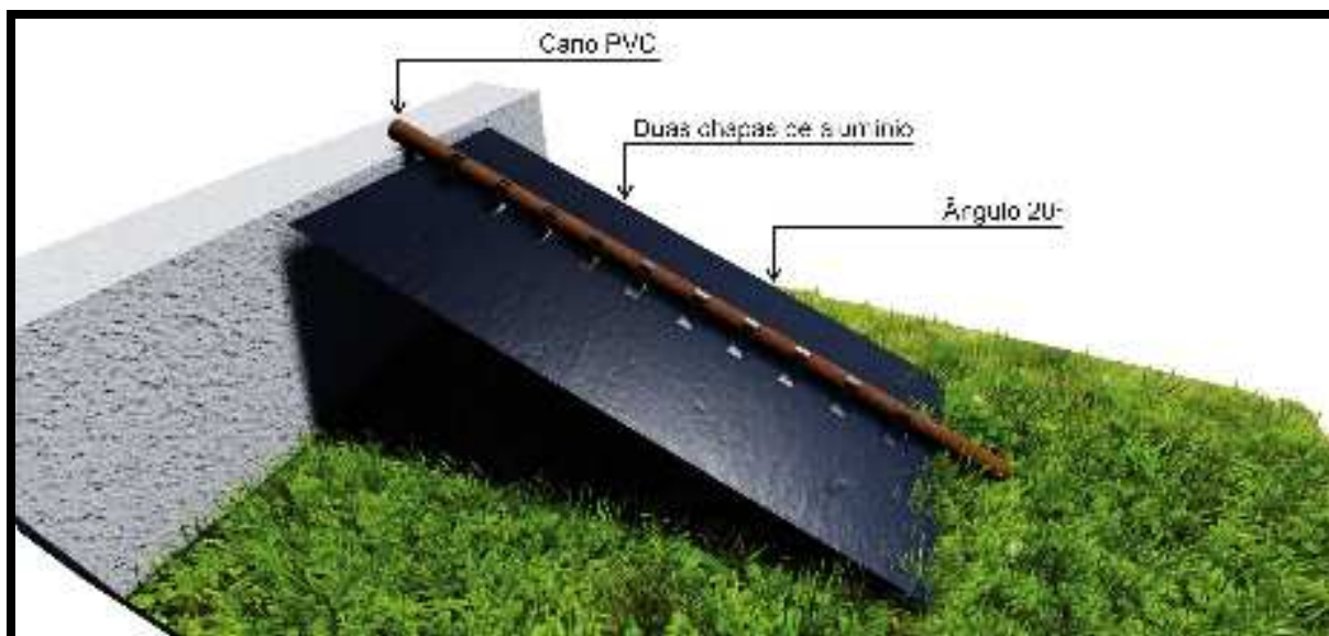
Figura 18 – Ilustração da unidade experimental com aleta
