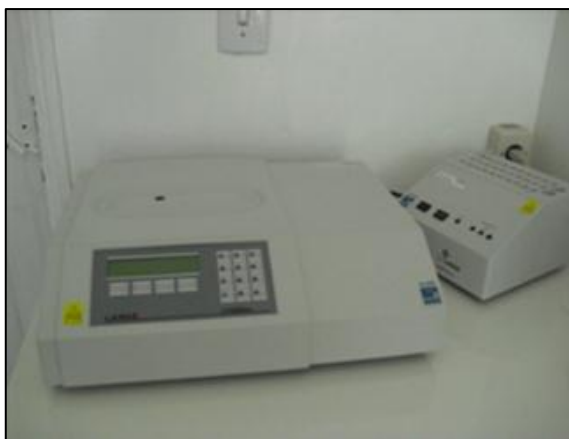
Figura 7 - Equipamento Luminímetro - LUMISTOX300 e termobloco FONTE: Autor
