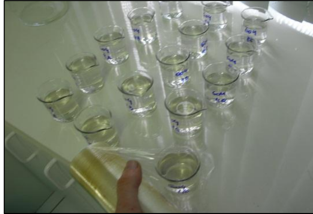
Figura 9 – Batelada de ensaios protegida pelo filme de PVC
