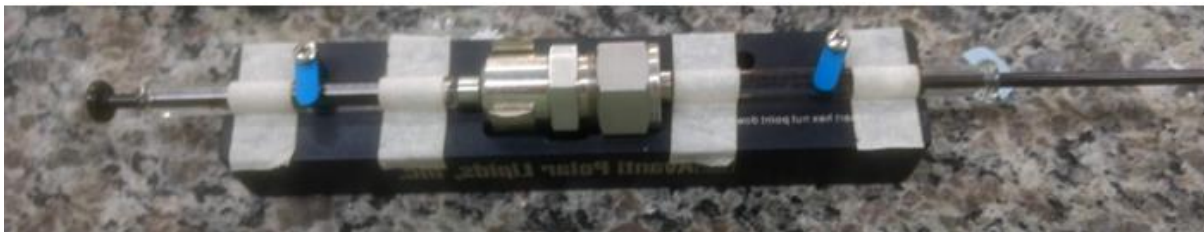
Figura 11 - Sistema de extrusão utilizado Fonte: Autoria própria
