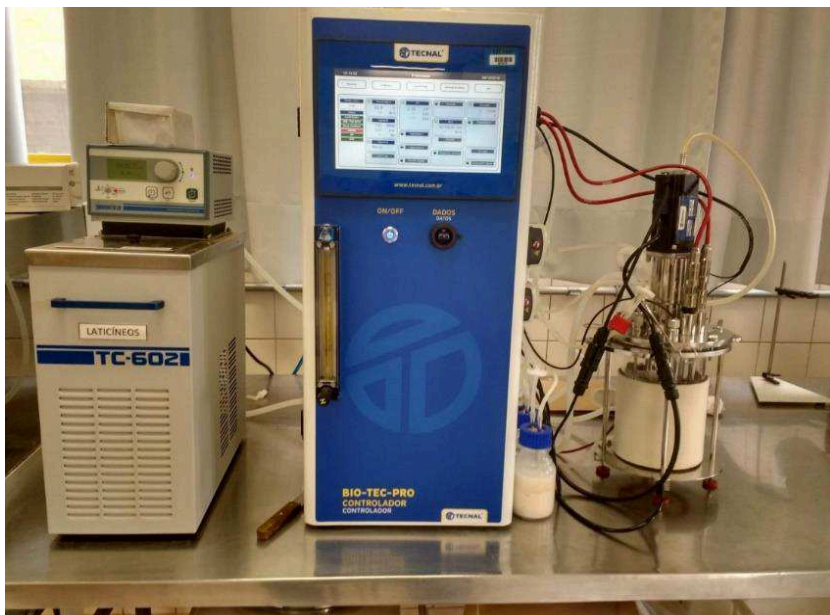
Figura 10. Cultivo da G. sulphuraria em biorreator de bancada.
