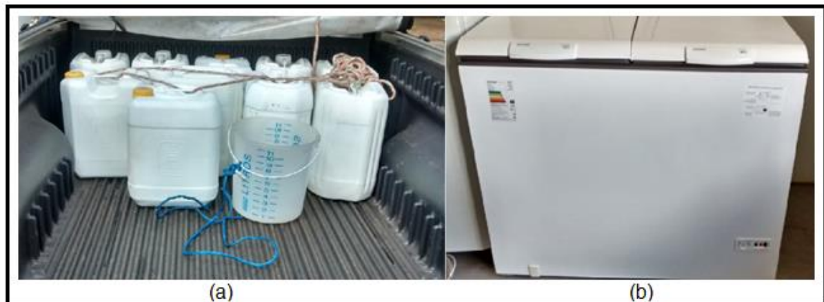
Figura 5 – Tanques e acessórios utilizados para coleta (a) e freezer de armazenamento do efluente (b).
