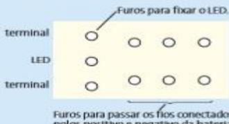
Dobre seus terminais e passe-os para a parte de cima da placa, usando os furos dos lados. Descasque as extremidades de um pedaço do cabinho para ligar o polo negativo do
