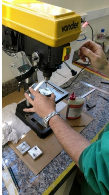
Fotografia 3 - Processo de furação dos aquecedores
