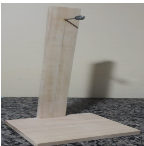
Figura 21: Suporte de madeira no qual será fixada a barra, para o desenvolvimento da atividade experimental. Fonte: Autoria própria.
