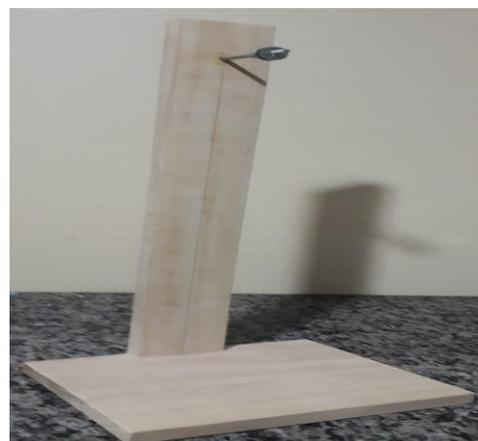
**Figura 7:** Ilustração do suporte para pêndulo físico.
