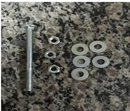
**Figura 8:** Ilustração do parafuso, porcas arruelas, para fixar a barra de madeira.
