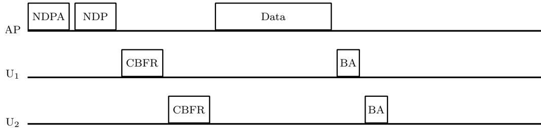
Figura 3 – Processo de sounding no modo Multi-Usuário para uma transmissão com 2 e 3 usuários em paralelo.
