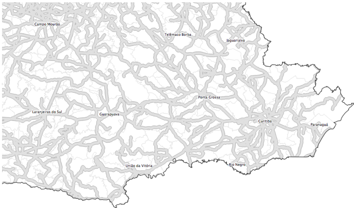
Figura 12: Buffer de 500 metros em torno do eixo das rodovias em cor cinza. Fonte: O Autor (2013).
