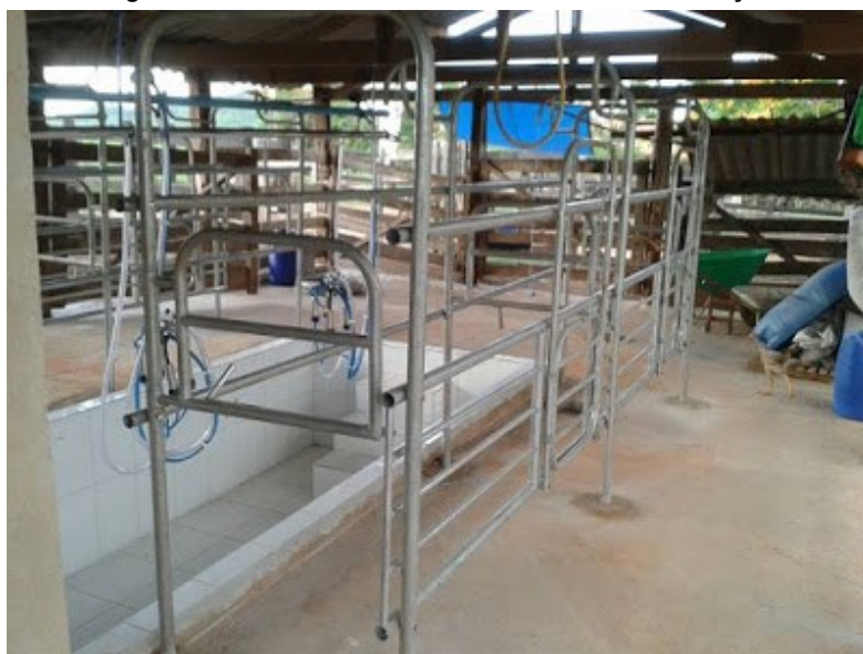
Figura 13 - Sala de ordenha estrutura de contenção
