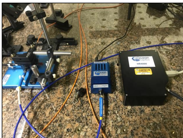
Figura 5: Montagem experimental para obtenção dos espectros de extinção.
