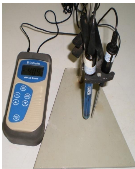
Figura 16 - Eletrodo seletivo de íon fluoreto utilizado para leitura de flúor.
