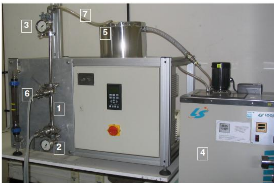
Figura 15 - Módulo experimental de micro-ultrafiltração utilizado no processo combinado.
