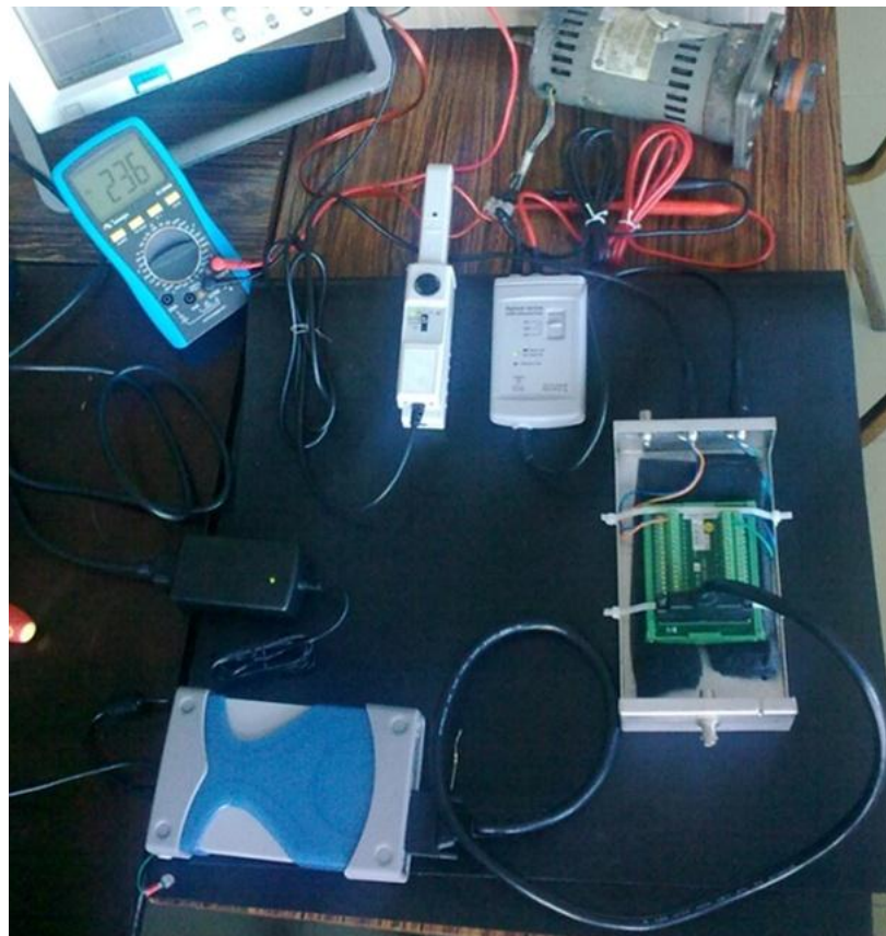
Figura 27 – Foto do circuito utilizado para realizar a amostragem (617 segundos a 10.000 amostras por segundo)
