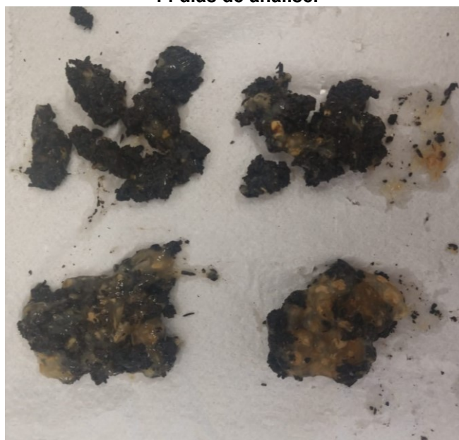
Figura 20 - Amostras de espuma desenvolvidas a partir dos subprodutos da batata (C20) após 14 dias de análise.
