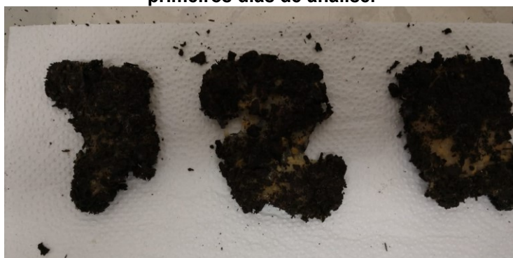
Figura 16 - Amostras de espuma desenvolvidas a partir dos subprodutos da batata (C15) nos 7 primeiros dias de análise.
