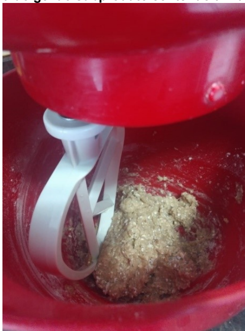
Figura 10 - Mistura do gel do subproduto contendo amido com os aditivos.
