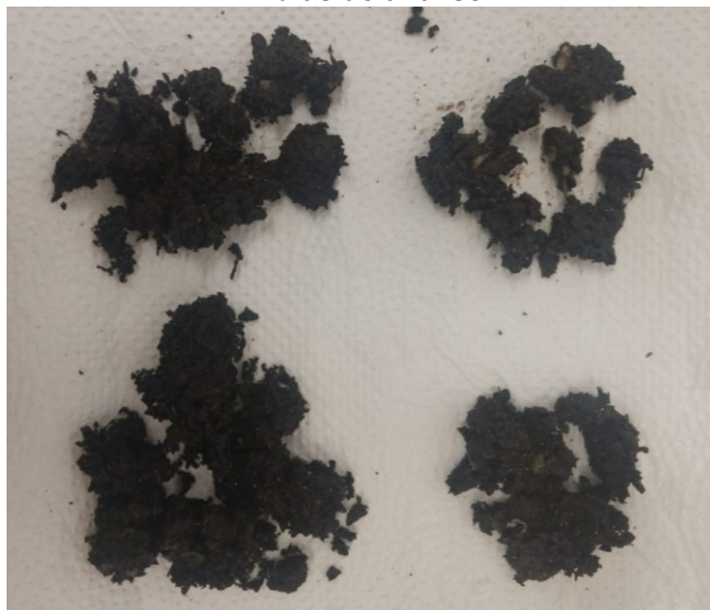
Figura 19 - Amostras de espuma desenvolvidas a partir dos subprodutos da batata (C15) após 14 dias de análise.
