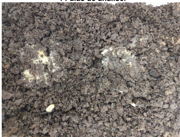
Figura 18 - Amostras de espuma desenvolvidas a partir dos subprodutos da batata (C10) após 14 dias de análise.
