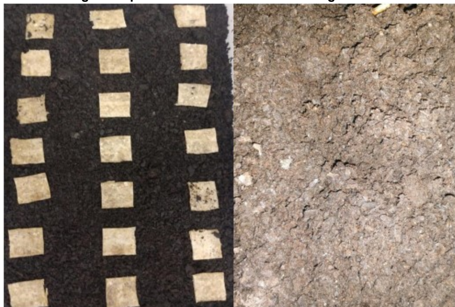
Figura 21 - Amostras de espuma desenvolvidas a partir dos subprodutos da batata no primeiro e no vigésimo primeiro dia da análise de biodegradabilidade.
