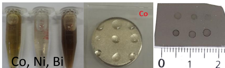
Figura 35 - Imagem dos coloides de nanopartículas (esquerda), do substrato de vidro sobre o ímã com gotas (2 \mu l) depositadas (centro) e o substrato já seco e pronto para uso, após secagem por 24h.
