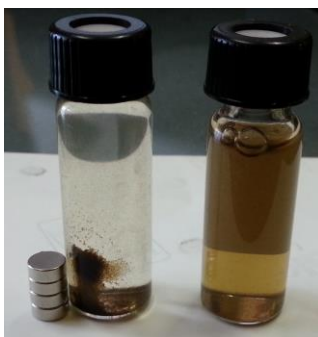
Figura 20 - demonstração do caráter ferromagnético das nanopartículas de Co, que são atraídas pelo ímã.
