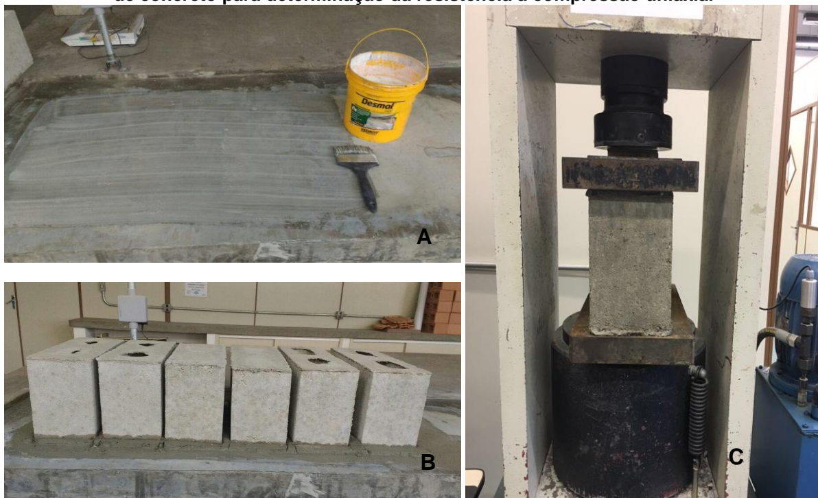
Figura 22 – Ensaio de resistência à compressão uniaxial dos blocos de concreto. A) Aplicação de desmoldante na bancada. B) Capeamento dos blocos de concreto. C) Rompimento do bloco de concreto para determinação da resistência à compressão uniaxial
