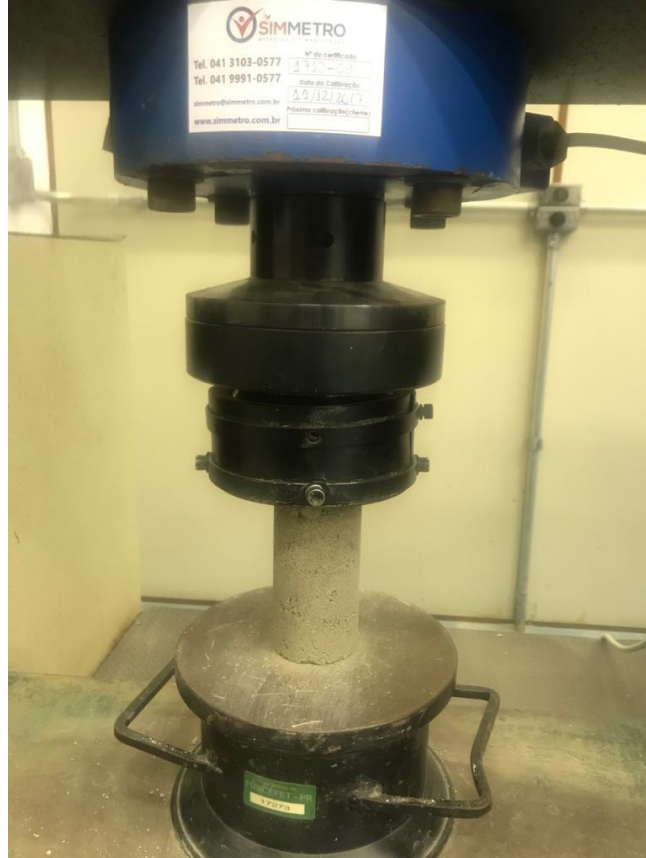
Figura 15 – Ensaio de resistência à compressão uniaxial dos corpos de prova
