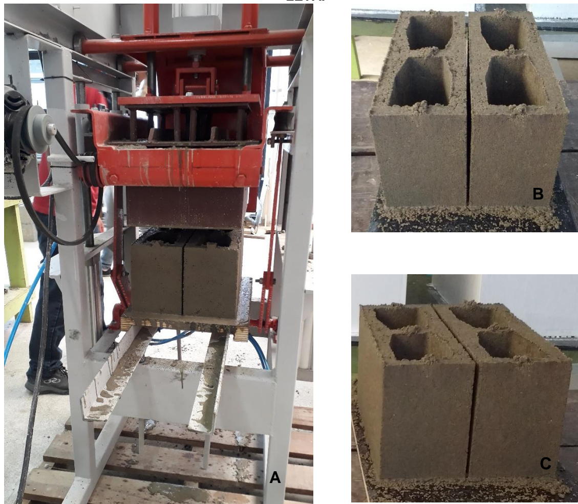
Figura 21 – Preparo dos blocos de concreto. A) Fabricação dos blocos de concreto na vibroprensa semiautomática. B) Bloco de concreto de referência. C) Bloco de concreto com LETA.
