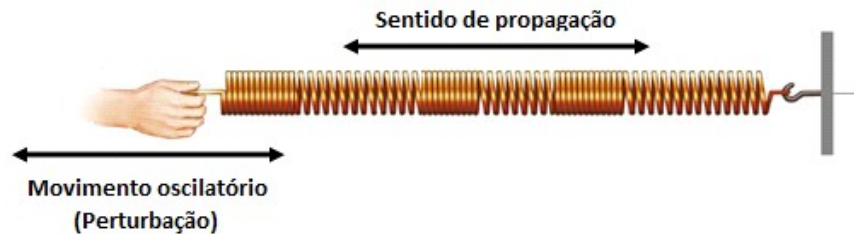
Figura 2: Representação de uma onda longitudinal
