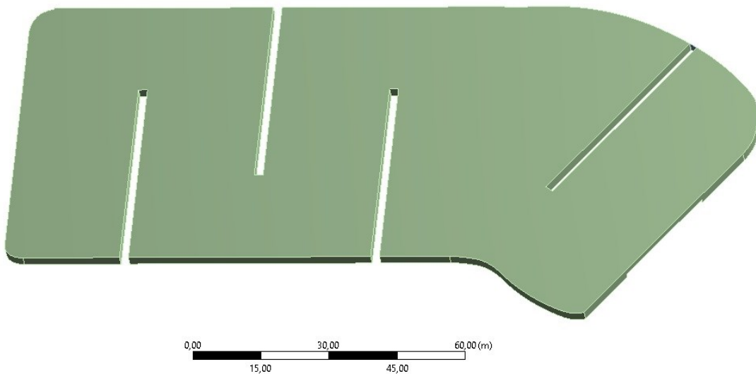
Figura 5 - Primeiro modelo de disposição das quatro chicanas na lagoa da ETE - Campo Mourão
