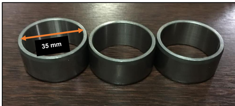
Figura 12 - Anel normalizado adaptado para o tribômetro Reichert test .
