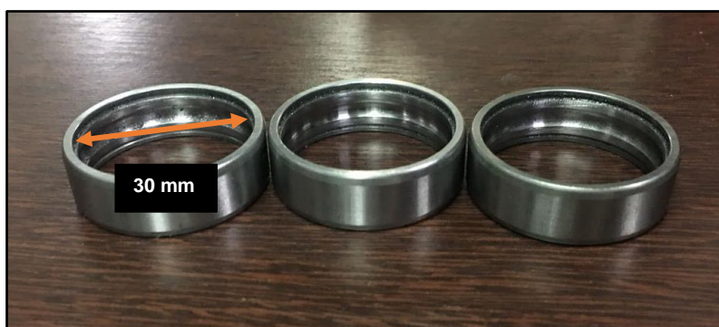
Figura 10 - Anel externo de rolamento adaptado para o tribômetro Reichert Test . Fonte: Autoria própria.
