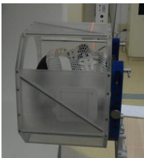
Figura 27: Caixa de localização para radiocirurgia fixada na base estereotáxica, utilizada pelo sistema de planejamento para obter as coordenadas da localização do volume de tratamento.
