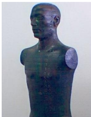
Figura 17: Alderson Rando Phantom. Objeto simulador utilizado para experimentos de radioterapia.
