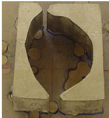
Figura 2: Bloco de Cerrobend utilizado em tratamentos de radioterapia para colimar o feixe de radiação à região de interesse.
