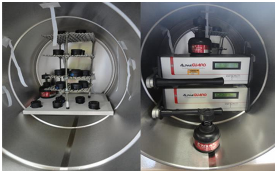
Figura 14- Distribuição dos detectores passivos e ativos no arranjo experimental do sistema de calibração
