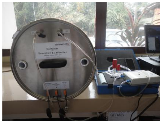
Figura 15- Circuito utilizado para as medidas do container de baixa exposição
