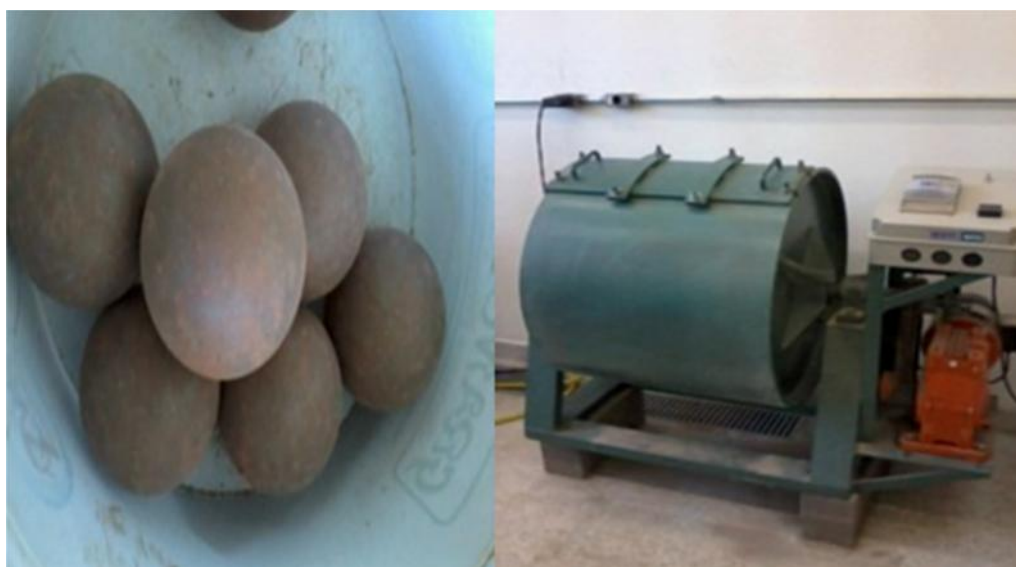
Figura 24- Moinho de bolas Solotest. Técnica Abrasão Losangeles
