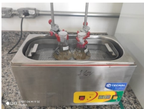
Figura 11: Processo de extração em banho ultrassônico
