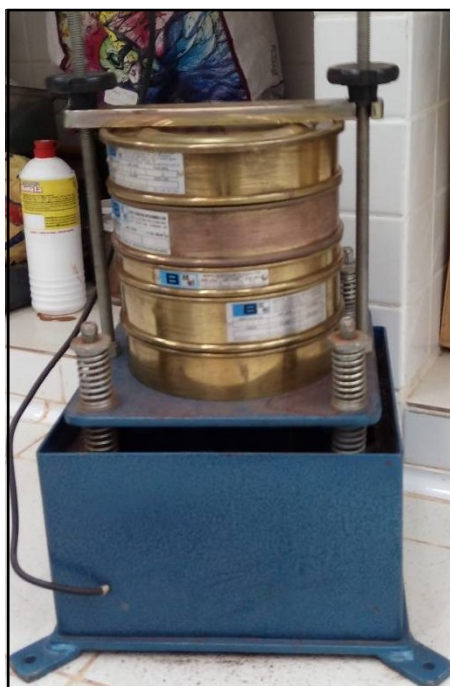
Figura 9. Equipamento utilizado para peneirar o solo
