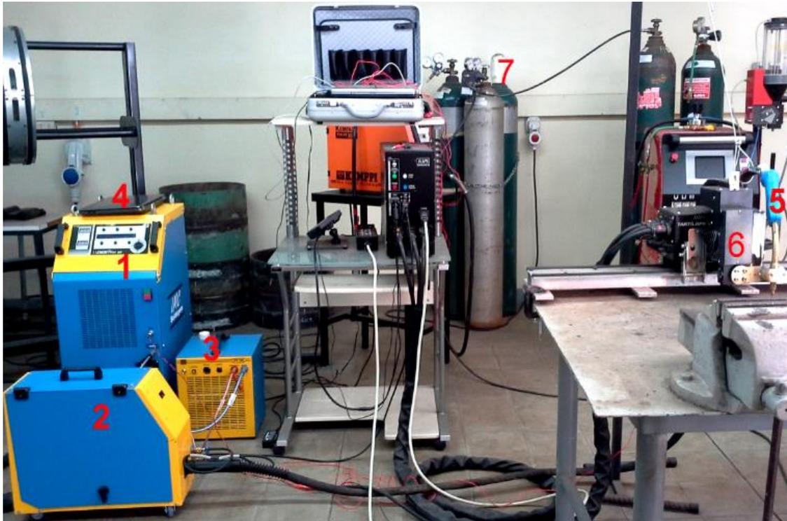
1: Fonte de soldagem; 2: Alimentador de arame; 3: Sistema de refrigeração da tocha; 4: Sistema de aquisição de dados; 5: Tocha; 6: Sistema de deslocamento da tocha; 7: Gases de proteção.
