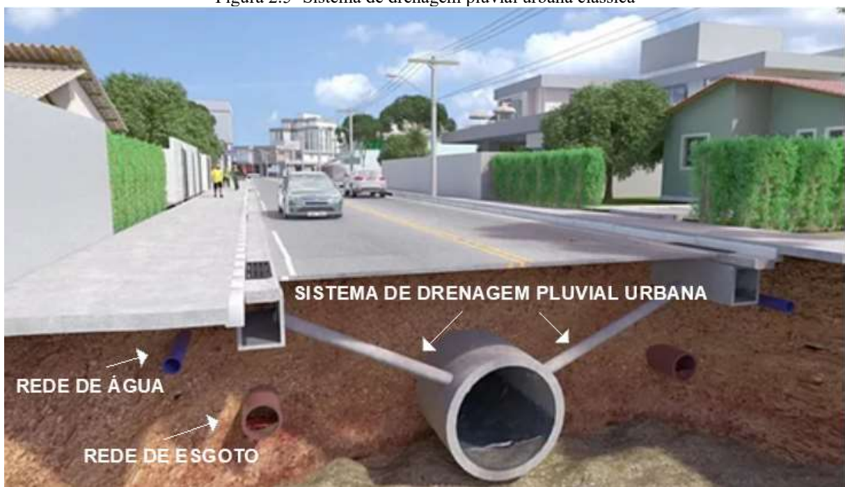
Figura 2.5- Sistema de drenagem pluvial urbana clássica
