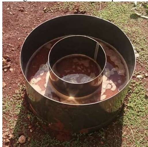
Figura 3.2- Infiltrômetro de duplo anel
