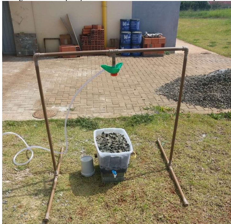
Figura 4.4 – Disposição simulador de chuva e vala de infiltração
