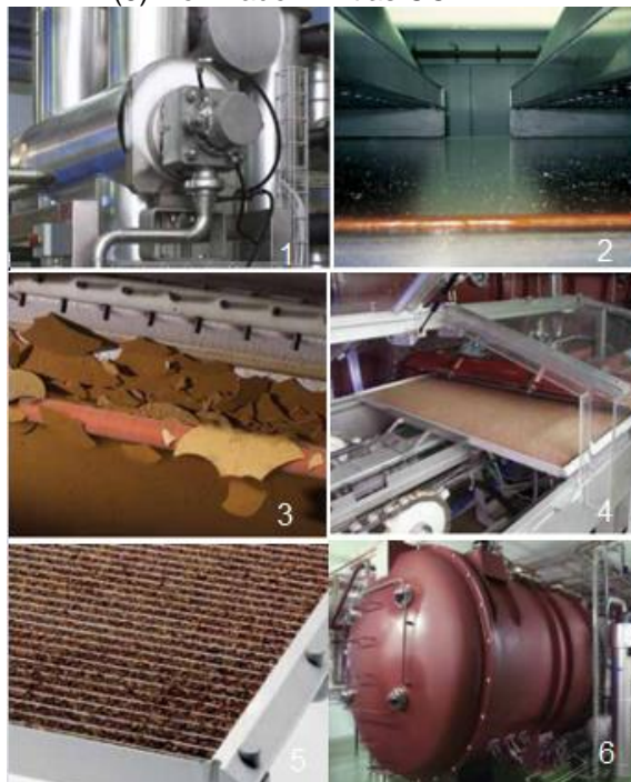
Figura 42-Ilustração do sistema de secagem: (1) Pré-congelamento; (2) Congelamento; (3) Granulação; (4) Adição da bandeja no liofilizador; (5) Café liofilizado; (6) Liofilizador – Atlas CONRAD.
