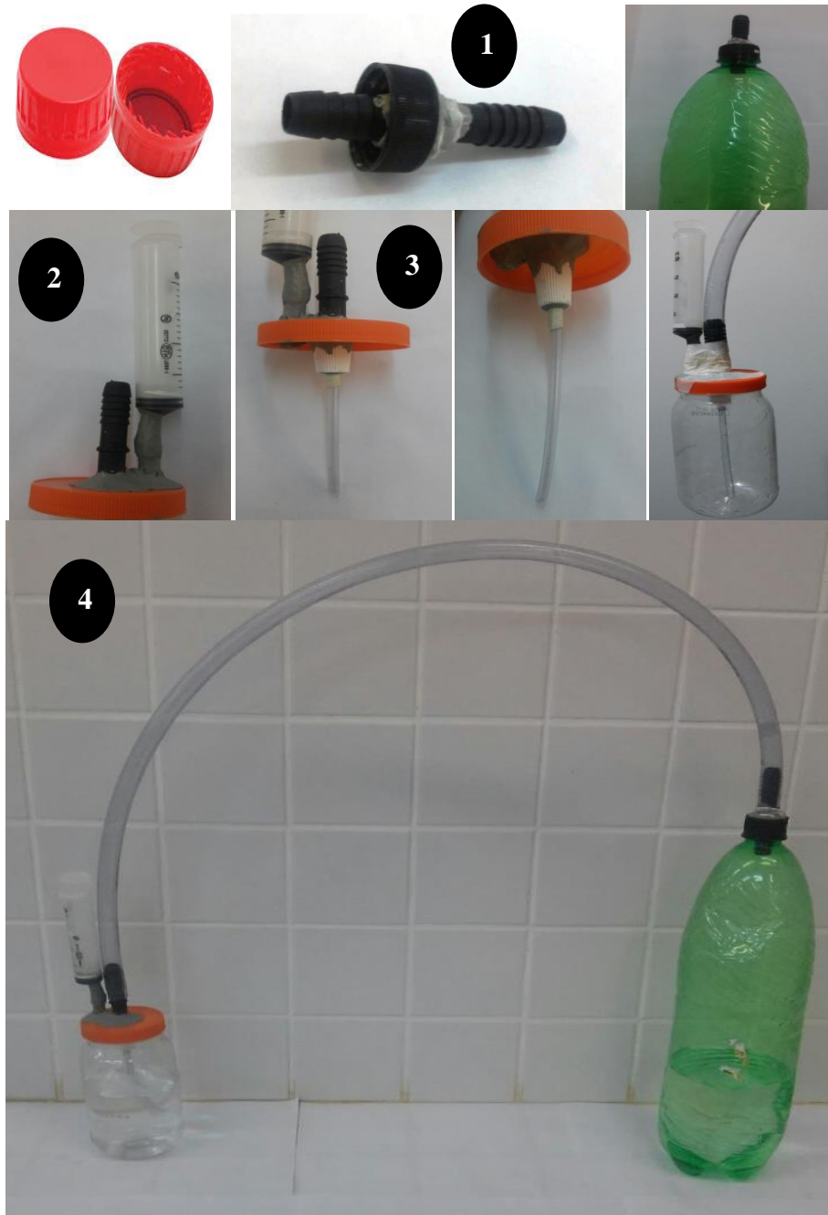
Figura 2: Montagem do sistema Fonte: Autoria própria
