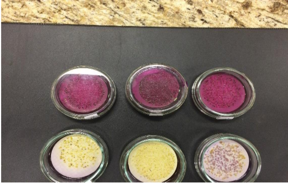
Figura 13: Análise microbiológica. Placas roxas com o meio M-endo e placas brancas com o meio M-TEC.
