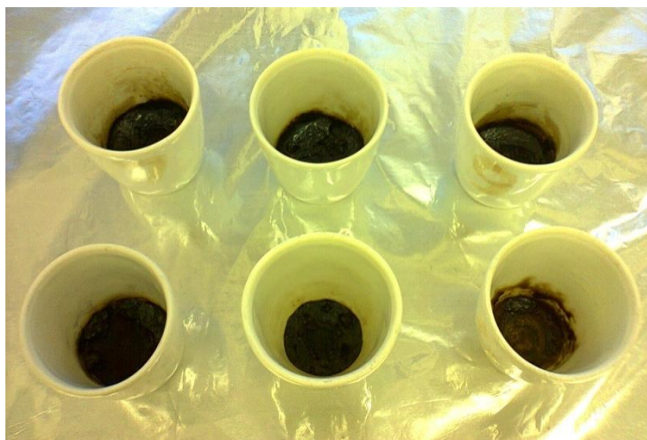
Figura 6: Resíduo nos cadinhos após a queima na chapa de aquecimento.
