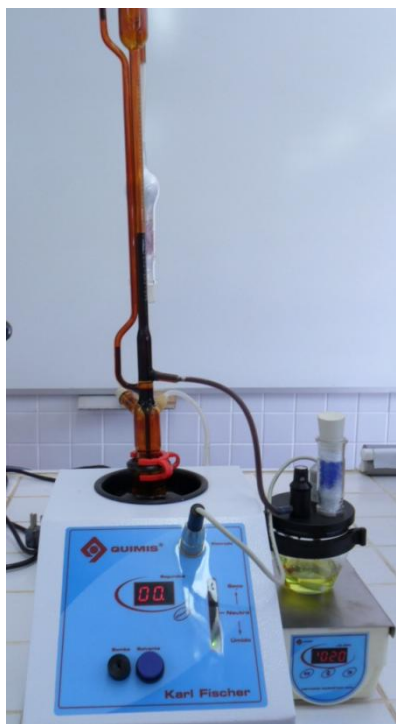
Figura 19: Aparelho de Karl Fischer para determinação da umidade.
