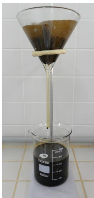
Figura 2: Filtração do óleo para remoção dos sólidos.
