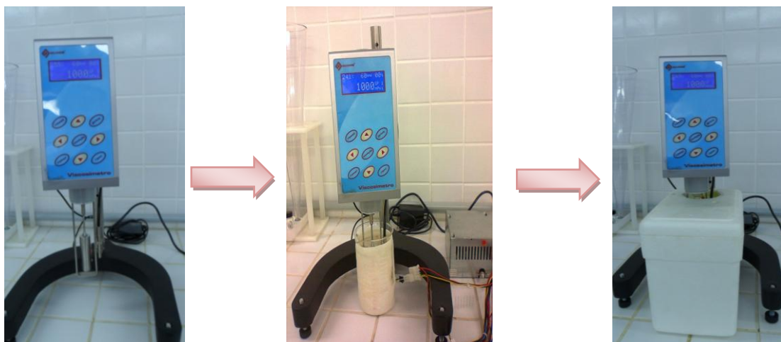
Figura 5: Determinação da viscosidade a 40°C - norma ASTM D445 (2006).
