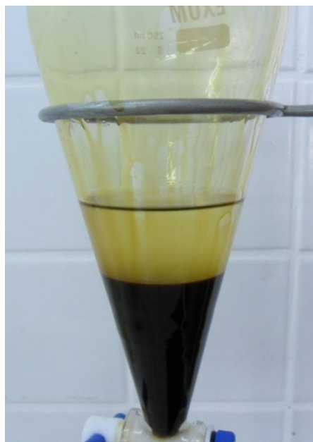
Figura 9: Separação de fases do hexano (superior) e da glicerina bruta (inferior).
