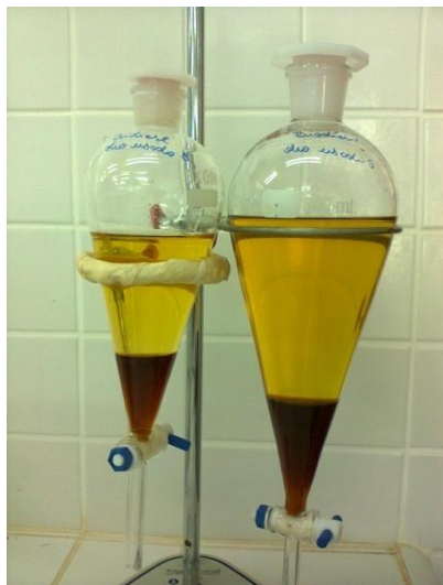
Figura 8: Separação do biodiesel (fase superior) da glicerina bruta (fase inferior).
