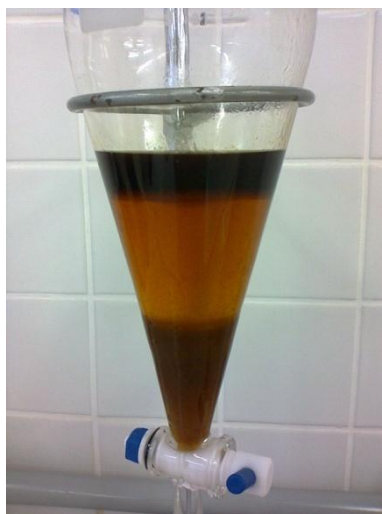
Figura 12: Separação das fases após a acidificação.
