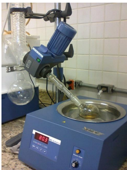
Figura 14: Processo de recuperação do solvente em evaporador rotativo.
