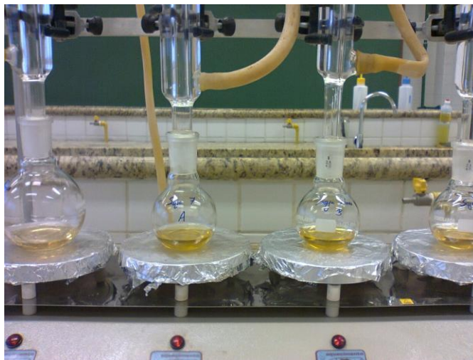
Figura 3: Determinação de Índice de Saponificação.
