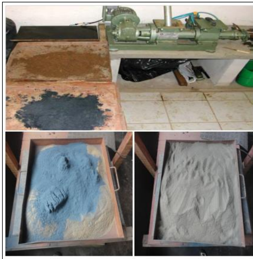
Figura 8 – Mistura do lodo com argila para produção dos blocos cerâmicos.
