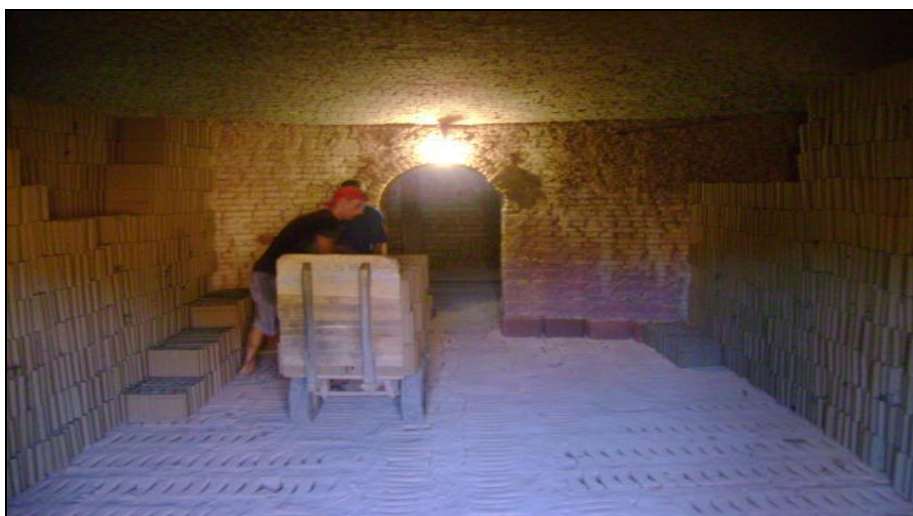
Figura 13 - Forno da indústria cerâmica para queima dos blocos
