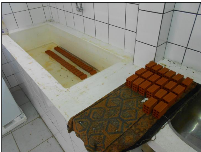
Figura 16 - Blocos mergulhados no recipiente preenchido com água e blocos na bancada para escoamento do excesso de água
