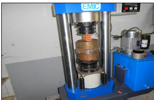
Figura 14 - Teste de resistência mecânica a compressão
