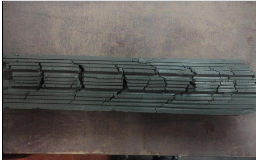
Figura 4 – Bloco cerâmico com formação de ‘escamas superficiais’
