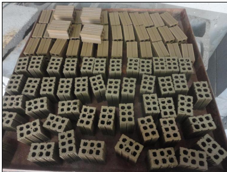
Figura 12 - Secagem dos blocos cerâmicos produzidos após confecção
