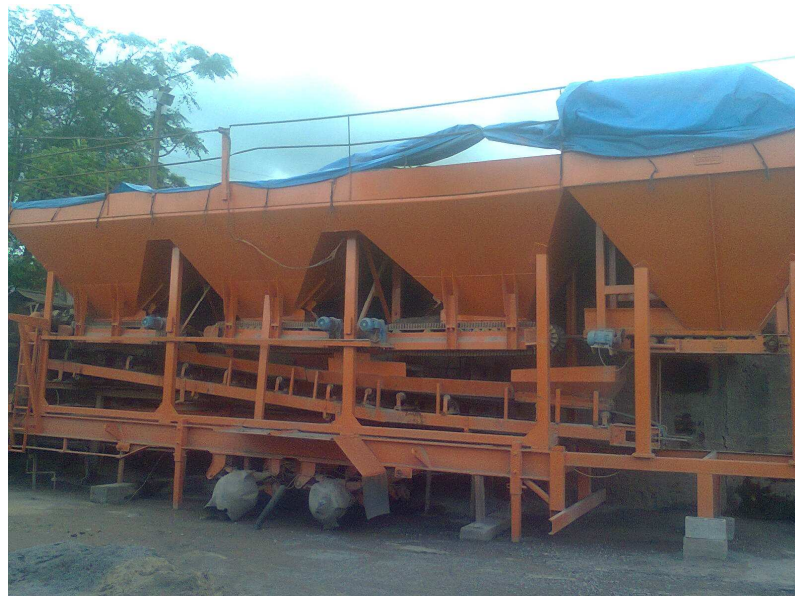
Figura 11 – Silos de agregados frios Fonte: O autor
