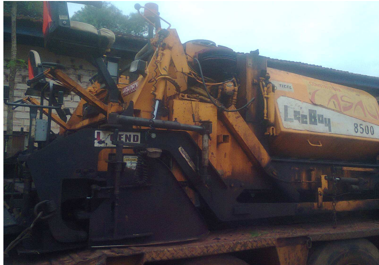
Figura 15 – Vibro acabadora Fonte: O autor
