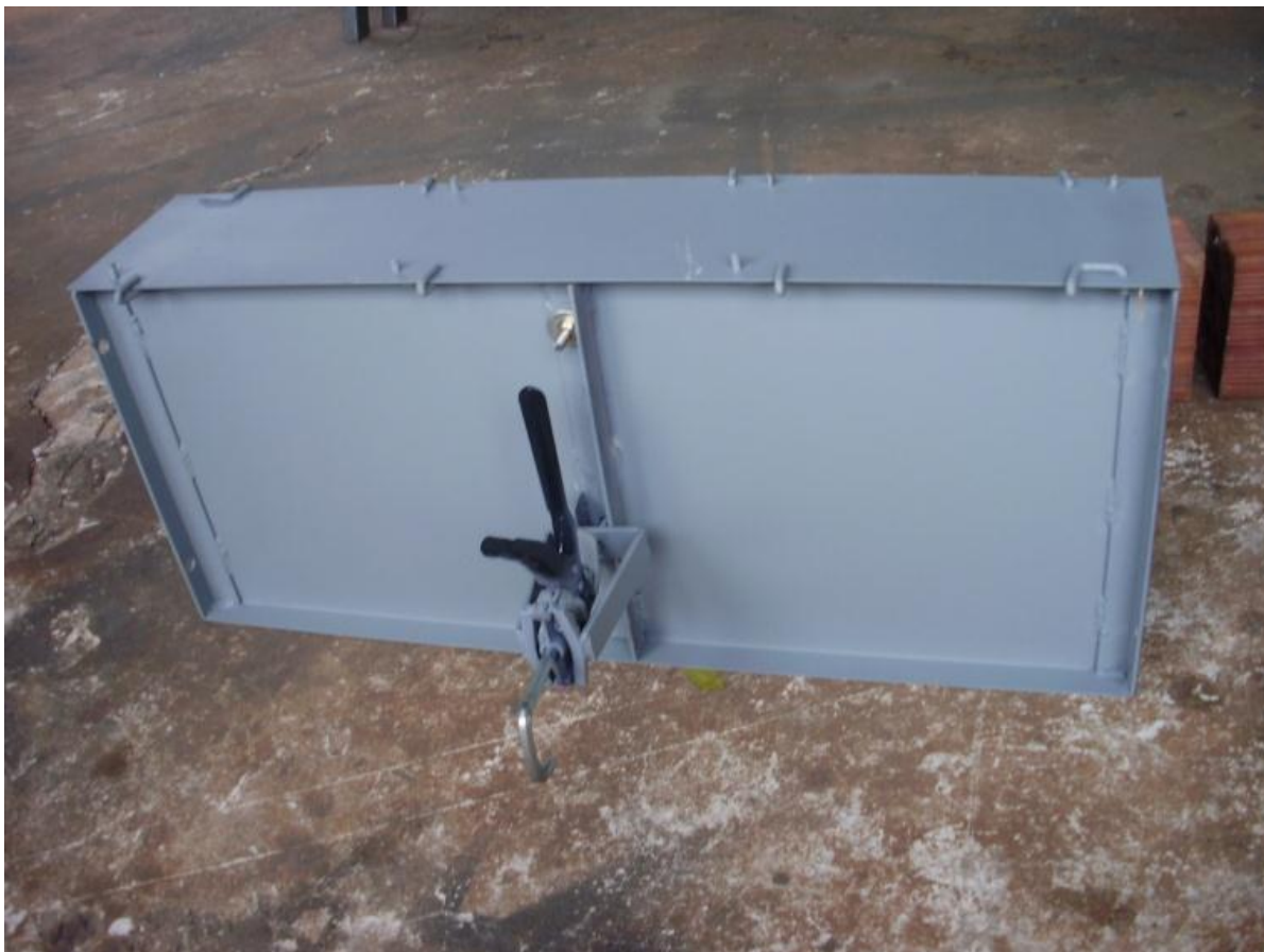
Figura 24 – Fundo fixado por meio de grampos Fonte: Autoria própria
