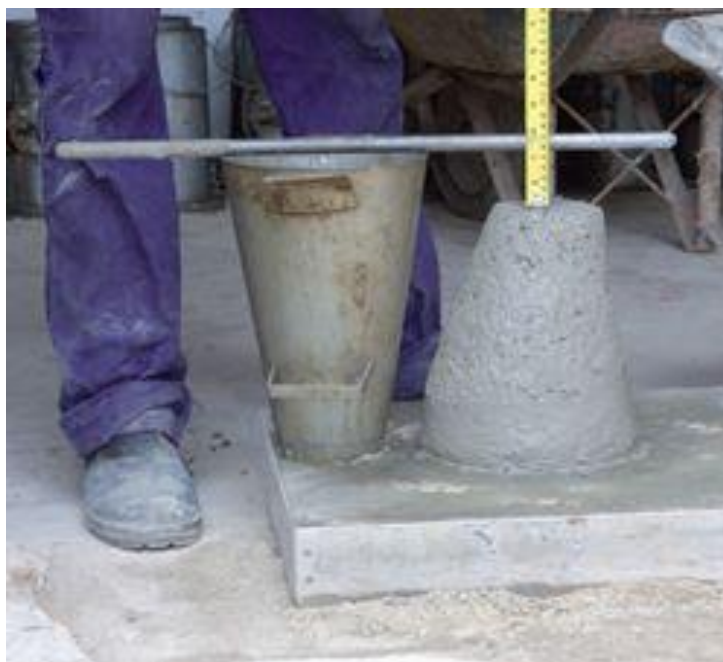
Figura 3 - Determinação da consistência pelo abatimento do tronco de cone Fonte PINI
