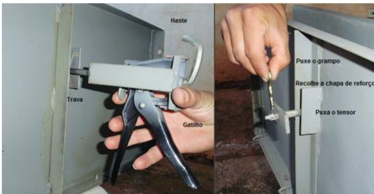
Figura 27 – Passo a passo para retirar o tensor Fonte: Autoria própria
